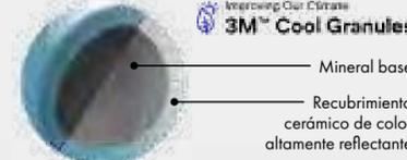
Las tejas con gránulos reductores de smog de 3M™ transforman su techo en una máquina purificadora de smog que hace el trabajo de **20 más árboles\***
